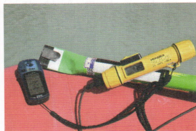
⑬⑭ 氷河池にボートを浮かべる ⑮⑯ GPS と測深器で、一部氷結
